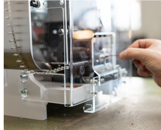
Arbeiten auf der neuen Abisolier- und Crimpmaschine
