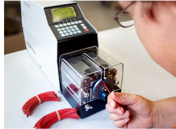
Arbeiten auf der neuen Abisoliermaschine
