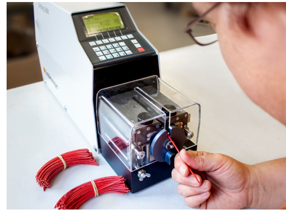
Travail sur la nouvelle machine de dénudage
